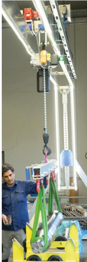
wird die Arbeit erleichtert und fordert weniger körperliche Anstrengung vom Anwender. Beim Arbeiten mit dem Alu-Portalkran mit elektrisch verfahrbarer Laufkatze ist kein persönlicher Kraftaufwand notwendig.
