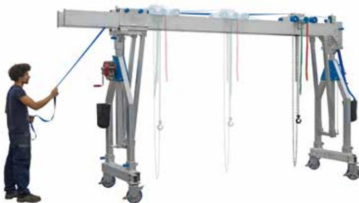
obodna traka za aluminijski portalni kran s pojedinačnim nosačem
