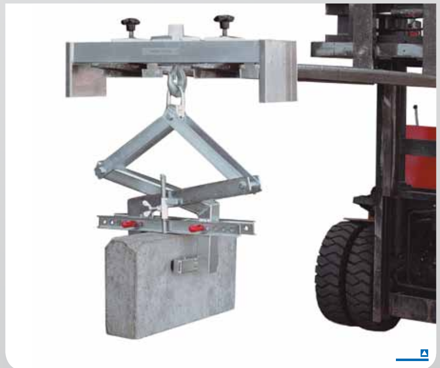
Travesaño de aluminio para toros con pinza (no incluido en el volumen de entrega)
